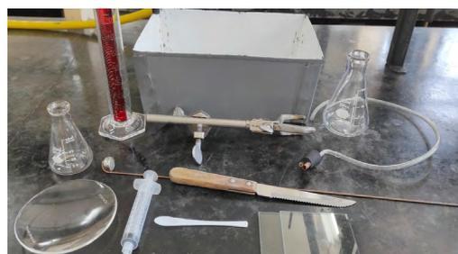
**Figura 1.** Materiales requeridos en el ensayo para la obtención de oxígeno molecular a escala de laboratorio.
