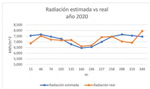
Figura 7. Radiación real vs radiación estimada con el modelo de Bristol Campbell para el año 2020
