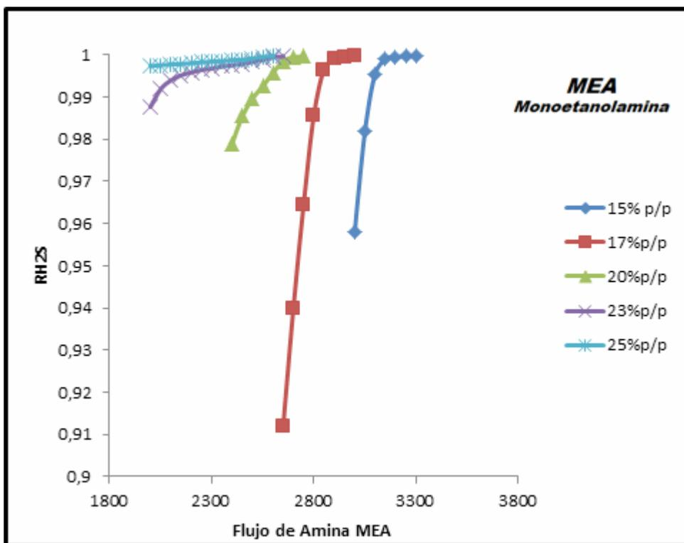
Figura 5. Flujo de Amina MEA a diferentes concentraciones en función de la fracción de remoción de H<sub>2</sub>S.
