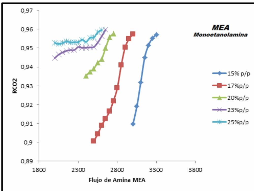
Figura 4. Flujo de Amina MEA a diferentes concentraciones en función de la fracción de remoción de CO<sub>2</sub>
