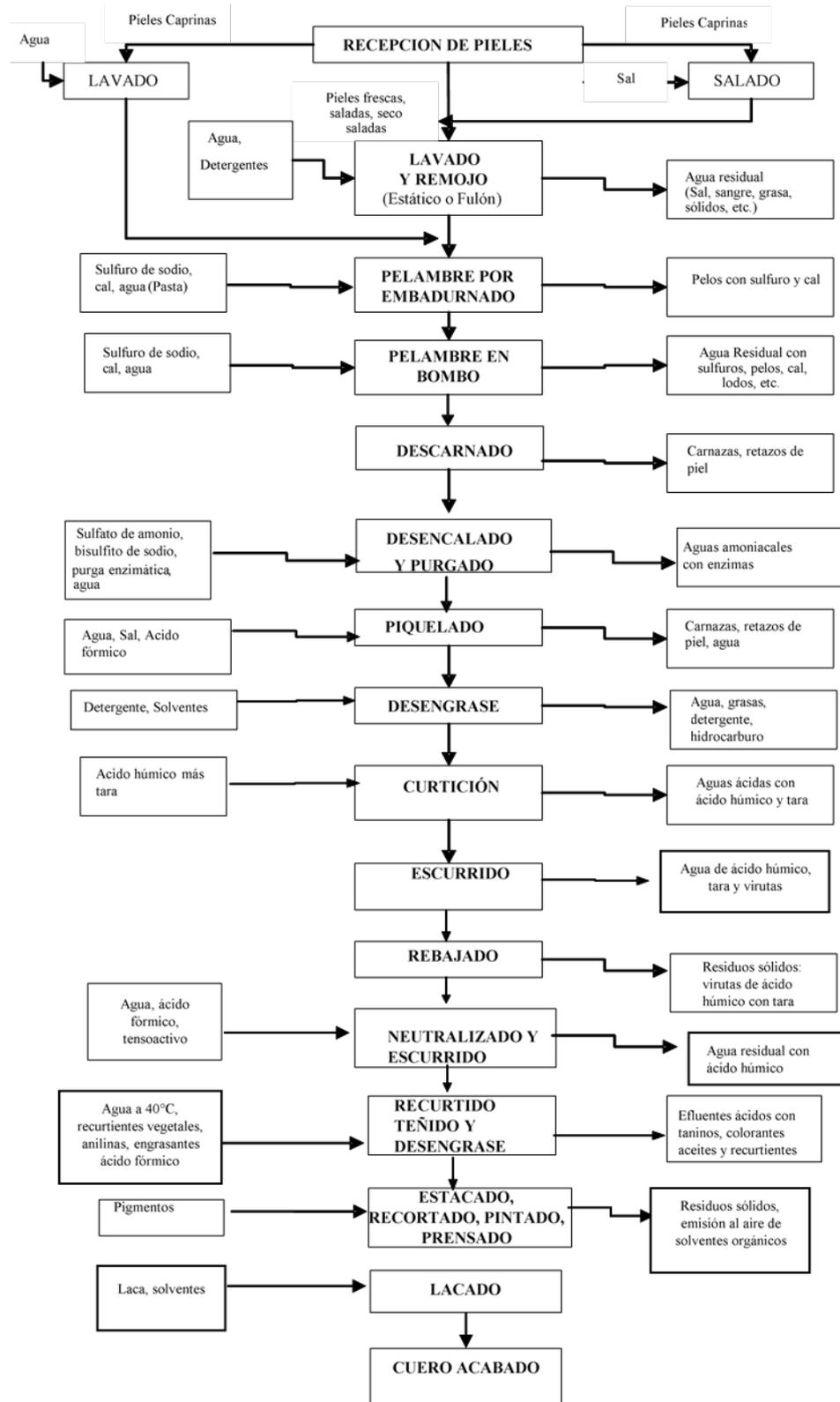
Figura 1: Diagrama de flujo con entradas y salidas del proceso de producción de pieles caprinas, (2018).
