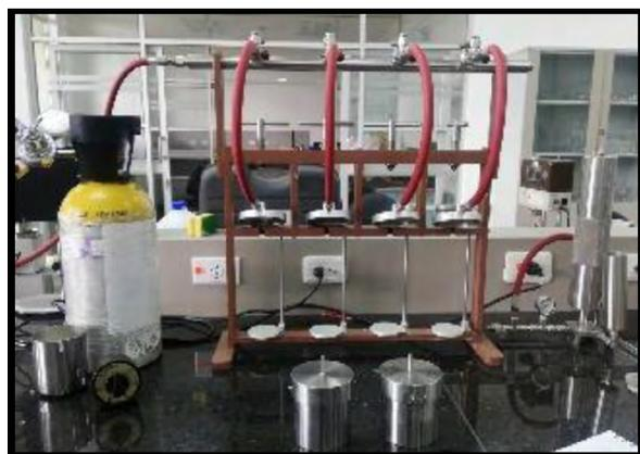
Figura 3. Equipo de filtración
