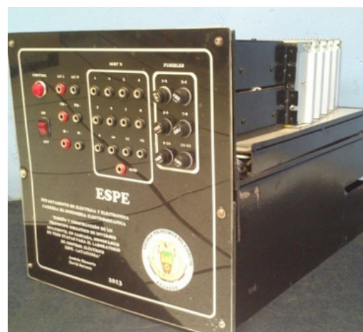
Figura 5. Módulo final del inversor multi-nivel didáctico monofásico en cascada.
